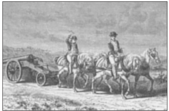
Fig.4 - Franse kanonnières van de Artillerie volante verplaatsen het stuk met paarden ( la prolonge ). De Artillerie volante had geen voorwagens, de paarden trokken met de knuppel de affuit.
